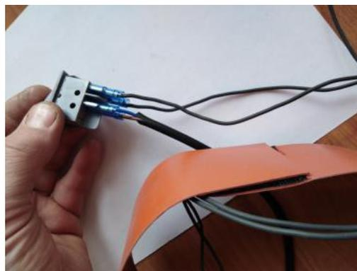
4. Установить клавишу включения обогрева в панель и проверить работоспособность;
