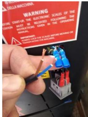
3. Установить пояс на внутренний бак и подключить провода к клавише включения обогрева;
