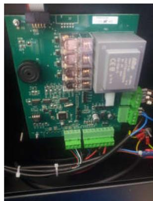
2. Устанавливаем плату питания принтера, подключаем провода и разъём:
