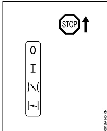
**STOP либо 0 – двигатель остановлен – зажигание выключено**
