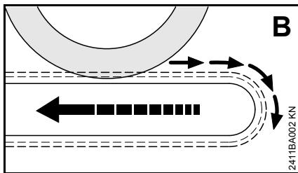
Если при абразивно-отрезной резке верхней стороной направляющей шины – задний рез – алмазная абразивно-отрезная цепь защемляется или наталкивается на твердый предмет в древесине, то устройство для резки камня может резко отбросить в сторону пользователя.
