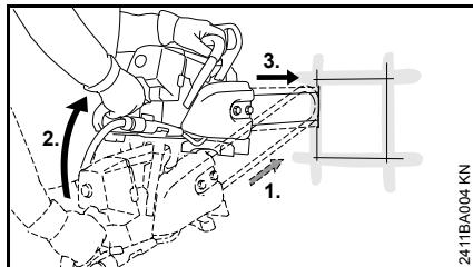
1. Направляющую шину установить нижней стороной верхушки шины
