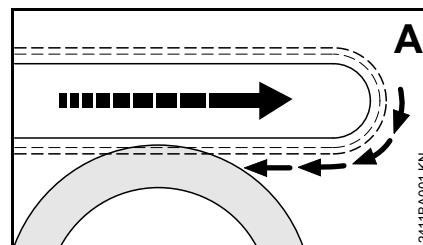
Если при абразивно-отрезной резке нижней стороной направляющей шины – передний рез – алмазная абразивно-отрезная цепь
