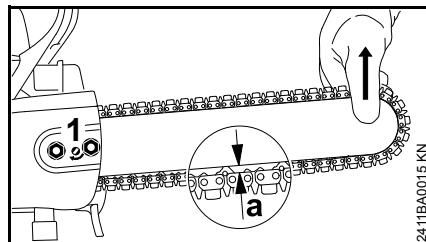
Для дополнительного натяжения пильной цепи во время эксплуатации:
