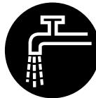
Алмазную абразивно-отрезную цепь использовать только с водой. Устройство для резки камня подсоединить к водопроводной сети (мин. 1,5 бар)
