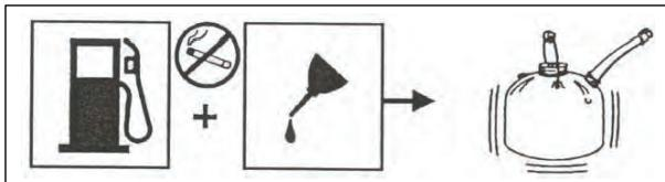
1. Страйтесь при заправке не пролить топливо на корпус триммера. Обязательно удаляйте пятна топлива с корпуса инструмента, перед его включением.
