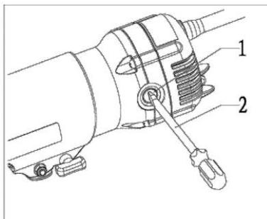
Для поддержания БЕЗОПАСНОСТИ и ДОЛГОВЕЧНОСТИ изделия ремонт, проверка и замена угольных щеток, любое другое обслуживание и регулировка должны проводиться в уполномоченных центрах по техобслуживанию, всегда используя оригинальные сменные части.
