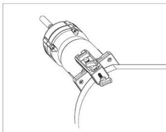
Установите кромкообрезную направляющую на основании инструмента с помощью зажимного винта (1). Ослабьте зажимной винт (3) и отрегулируйте расстояние между фрезой и кромкообрезной направляющей путем поворота регулировочного винта (1 мм за оборот). Установив необходимое расстояние, затяните зажимной винт (3) для закрепления кромкообрезной направляющей.
