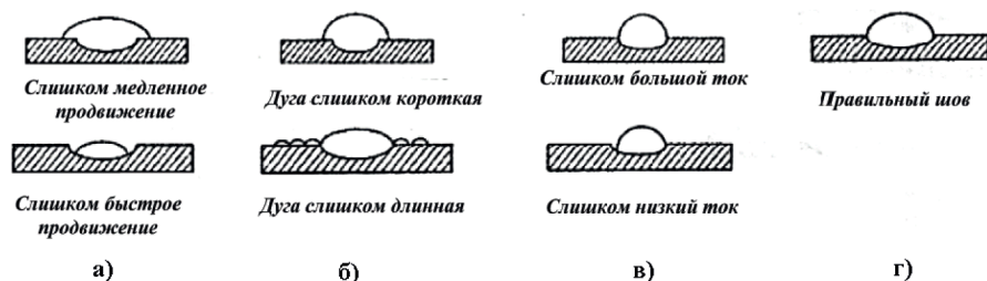
Рис. 3. Типы сварочных швов.
