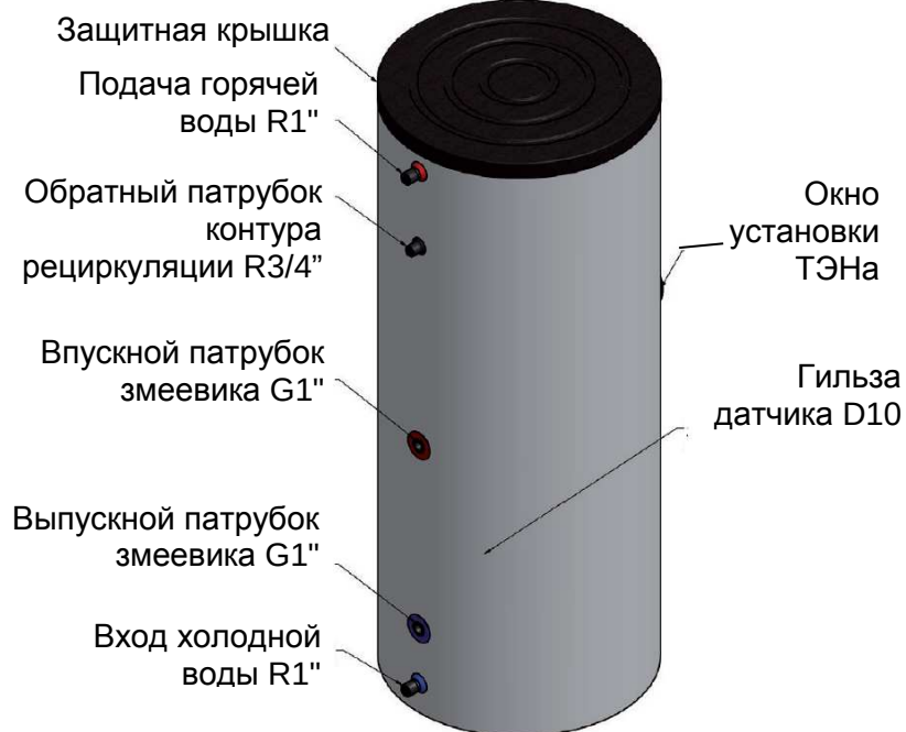
Водонагреватель с двумя теплообменниками-змеевиками 160-200 л
