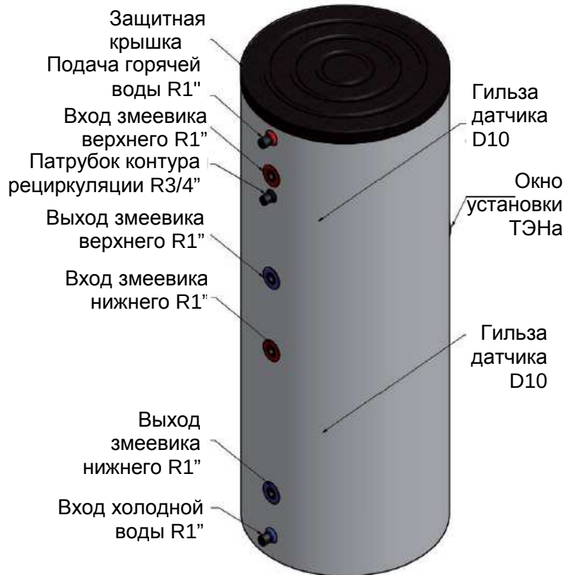
Водонагреватель с двумя теплообменниками-змеевиками 160-200 л
