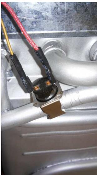
**Датчик перегрева воды** обеспечивает отключение аппарата при перегреве воды.
