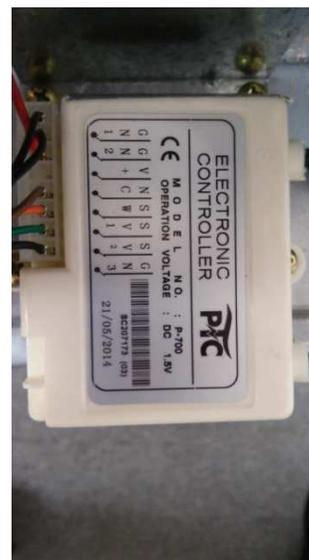
**Блок управления** обеспечивает управление розжигом и подачей газа на горелку
