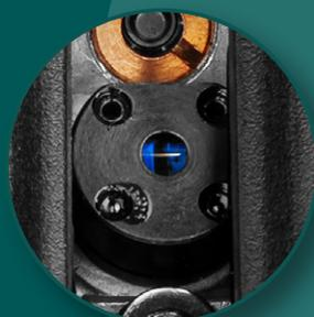
Магнитный компенсатор для самовыравнивания
