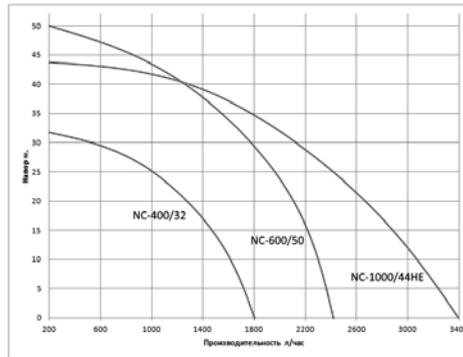
Приведенные характеристики справедливы при нулевой высоте всасывания и минимальных сопротивлениях потоку во всасывающей и напорной магистрали, при напряжении питания 220 В. Следует иметь в виду, что при увеличении высоты всасывания, а так же при отклонении напряжения питания характеристики насосов ухудшаются.
