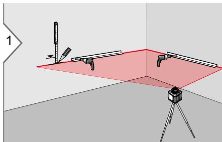
1 Включить лазер. Отрегулировать высоту лазера по известной опорной отметке для точек крепления. Использовать автоматический режим или режим сигнала тревоги H.I. и дать лазеру выполнить самовыравнивание.
