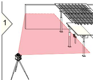
Включить лазер. Использовать автоматический режим или режим сигнала тревоги Н.И. и дать лазеру выполнить самовыравнивание.
