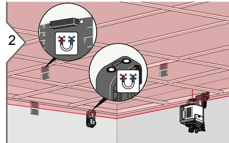
Включить лазер. По необходимости отрегулировать высоту лазера. Использовать автоматический режим или режим сигнала тревоги H.I. и дать лазеру выполнить самовыравнивание. Использовать визирную пластину или приемник для выравнивания подвесной потолочной решетки.
