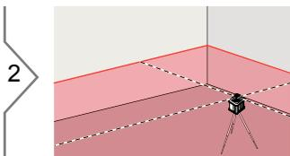
После включения запускается автоматический режим. Как только прибор выровнял самовыравнивание, головка лазера начинает вращаться.
