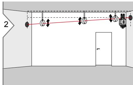
2 Отрегулировать трубные зажимы по лазерному лучу.
