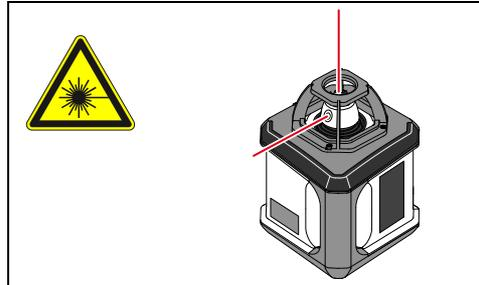
Прибор излучает видимые лазерные лучи из своей передней части: Изделие относится ко 2-му классу лазеров в соответствии с:
