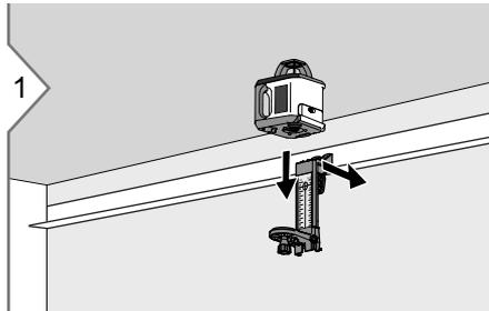
Закрепить первый потолочный профиль. Установить лазер на настенное крепление. Прикрепить настенное крепление к потолочному профилю.
