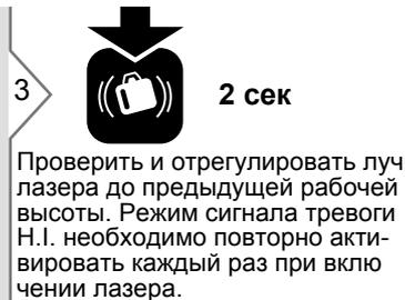
**i** Функция сигнала тревоги при изменении высоты или контроля высоты прибора предназначена для предотвращения неправильной работы из-за резкого перемещения или проседания штатива, что привело бы к выравниванию лазера на более низкой высоте.
