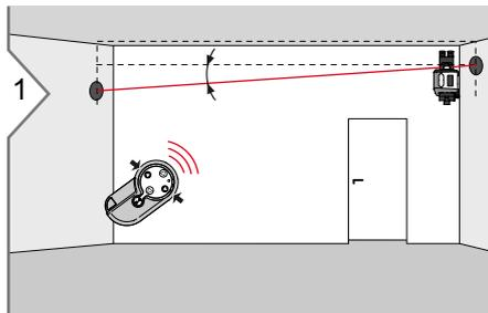
1 Закрепить лазер вместе в настенным креплением на стене. Переключиться в ручной режим. Наклонить лазерный луч к опорной отметке.
