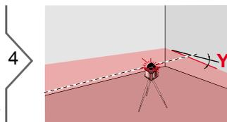
Наклонить ось Y плоскости лазера с помощью пульта.
