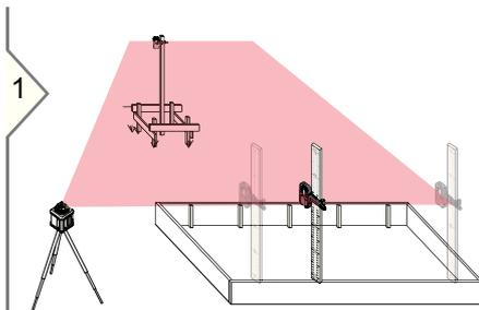
Включить лазер. Использовать автоматический режим или режим сигнала тревоги Н.И. и дать лазеру выполнить самовыравнивание.
