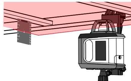
В настенном креплении, выравнивание с использованием визирной пластины
