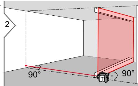
Переместить лазер на следующий участок. Повторить первый шаг, используя существующие отметки, как опорные. Закрепить профили для гипсокартона.
