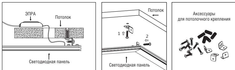
– Рисунок 4. Монтаж при помощи комплекта LP-KPP-K –
