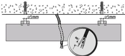
4. Установить корпус на поверхность потолка.
