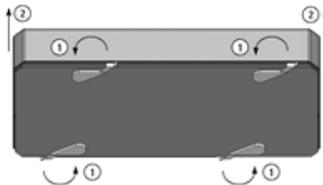
2. Вщелкнуть опору в корпус светильника.
