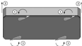
2. Вклацнути опору в корпус світильника.
