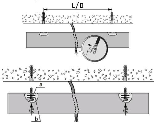
3. Корпус зафіксувати на опорній поверхні в заздалегідь підготовлених отворах за допомогою комплекту кріплення.
