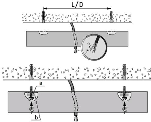
3. Корпус зафиксировать на опорной поверхности в заранее подготовленных отверстиях при помощи комплекта крепежа.
