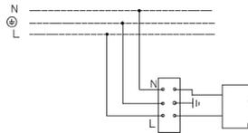
2. Схема підключення світильника до мережі живлення з блоком резервного живлення (на мал. а - блок резервного живлення).
