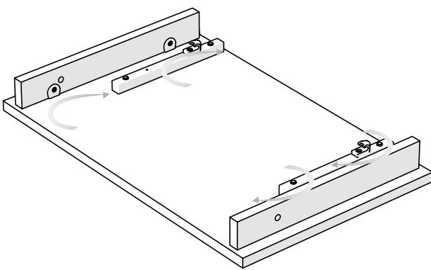
4 Вставьте опоры в крючки так, чтобы гайка-бочонок оказалась внутри
