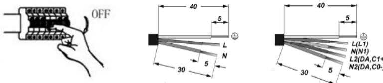
3. Підключити мережеві дроти до колодки на задній стінці корпусу відповідно до зазначененої полярності. При використанні регульованого драйвера, керуючі дроти підключаються строго з дотриманням полярності, зазначеної в маркуванні.
