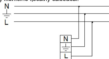
2. Резервтік құаттандыру блогы бар құаттандыру желісіне қосу сүлбасы : (сур. а - Резервтік құаттандыру блогы).
