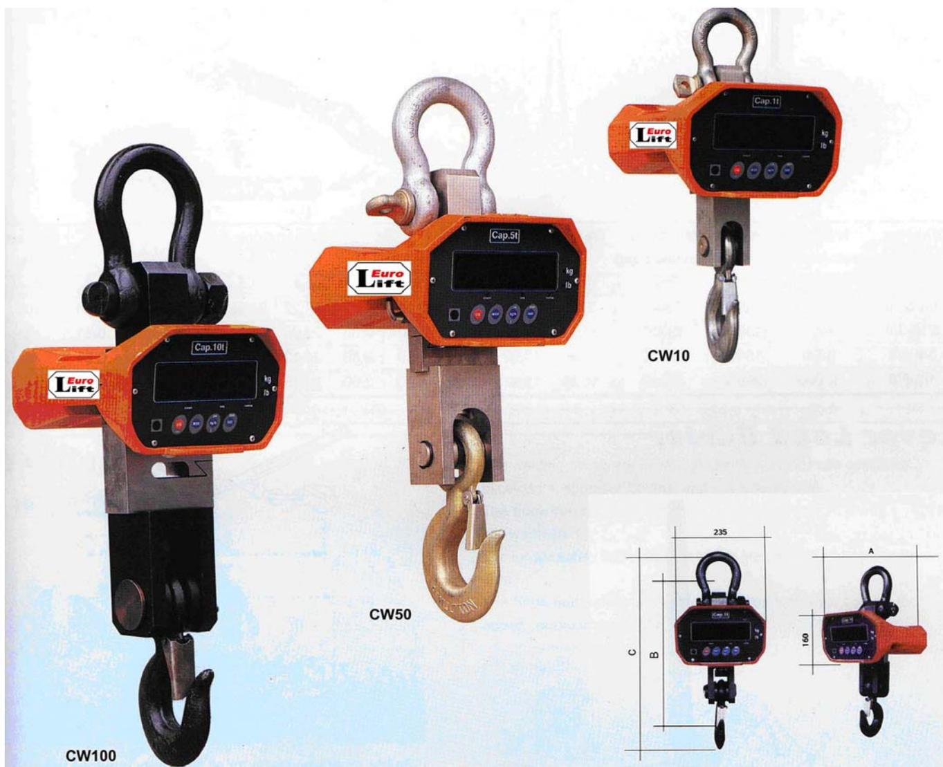
Компактный измерительный прибор для того, чтобы взвешивать грузы во время подъема. Весы для подъемного крана имеют жидкокристаллический дисплей, который может показывать вес тары, так же как показывать вес нетто или брутто. Он также показывает защиту от перегруза в 110 % веса брутто и статуса батареи.
