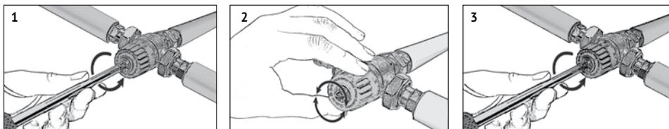
Клапан предварительно настроен на температуру 40 °С при входящей горячей воде 70 °С и входящей холодной воде 15 °С.
