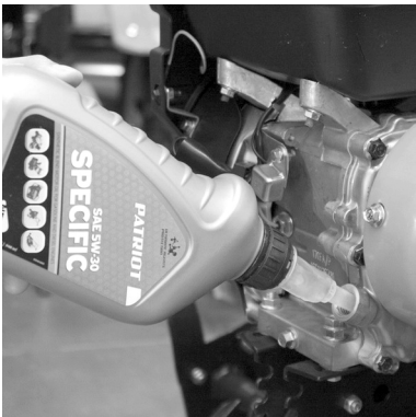
Заправка (дозаправка) масла в картер двигателя
