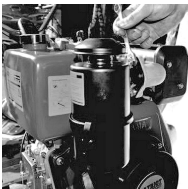
Шаг 10. Установить воздушный фильтр на колено впускного коллектора двигателя, и закрепить
