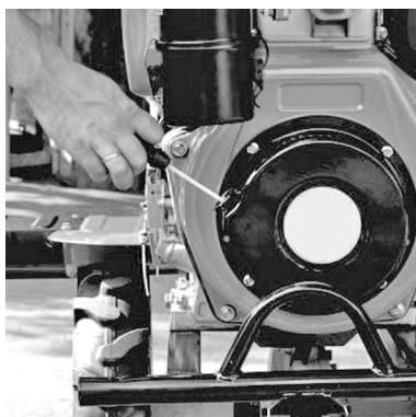
Вытягивание шнура ручного стартера
