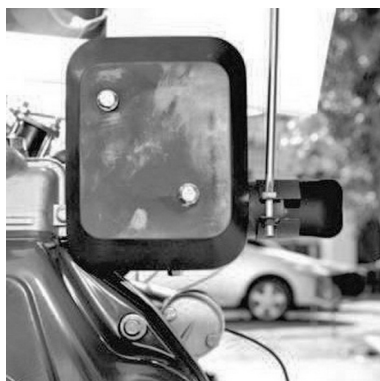
Шаг 11. Установить короб глушителя-искроулавливателя на выпускной патрубок двигателя
