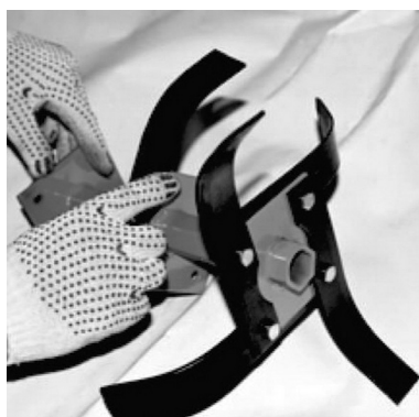
Шаг 14. Прикрепить ножи к секциям почвофрезы. Изготовить (укомплектовать) левостороннюю и правостороннюю почвофрезы, ориентируя ножи так, чтобы при вращении фрезы они заходили в грунт заточенными гранями
