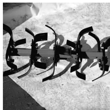
Шаг 15. Соединить секции почвофрезы воедино с помощью соединительных пальцев и шплинтов
