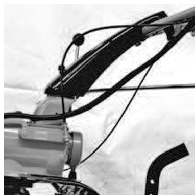
Шаг 7. Соедините все рукоятки органов управления с соответ- ствующими рычагами управле- емых механизмов, соответствую- щими тросами-бодунами.
