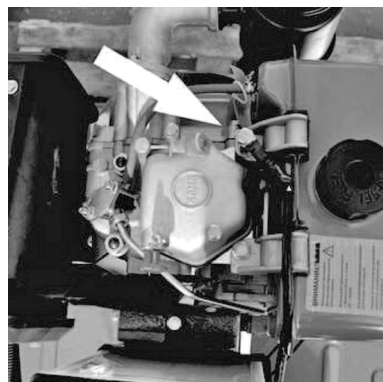
Подсоединение силового кабеля к клемме (винту) «масса» на корпусе двигателя.
