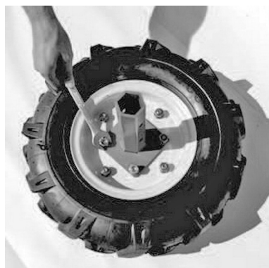
Шаг 1. Прикрепить ступицы обоих колес к колесным дискам
