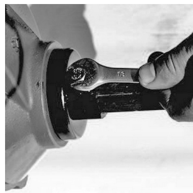
Шаг 3. Закрепить пыльники фиксирующими болтами
