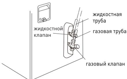
3. Предварительно затяните соединительную гайку рукой.
