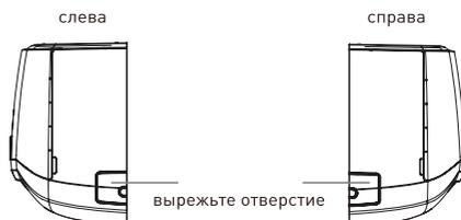
2. При выборе направления вывода трубы слева или справа, удалите соответствующую выштамповку в пластике нижней части корпуса блока.
