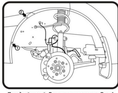
Передний левый. Демонтаж крепления. Рис. 1
