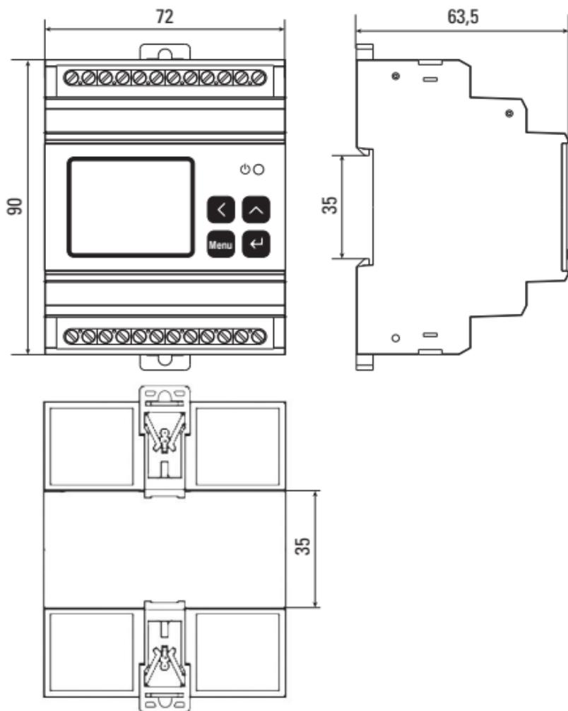
Рис. 1 Форма и размеры счетчика (мм)
