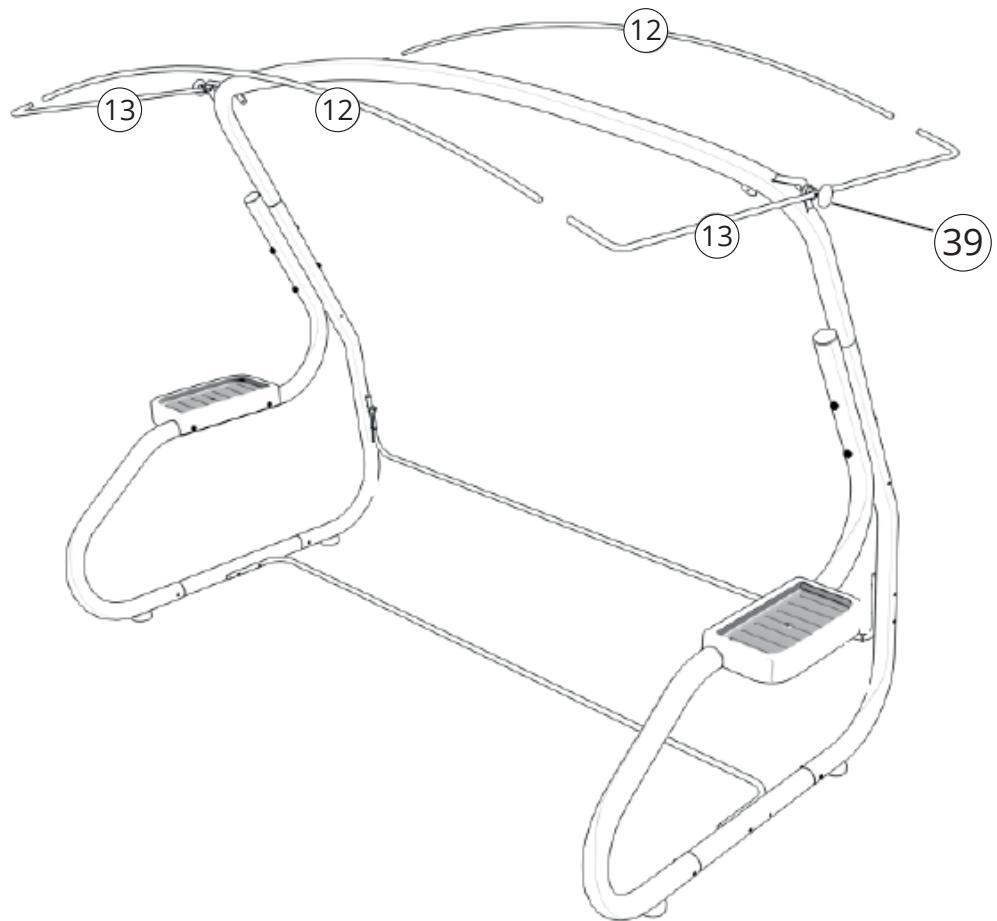
14. Сборка узла регулировки тента:
