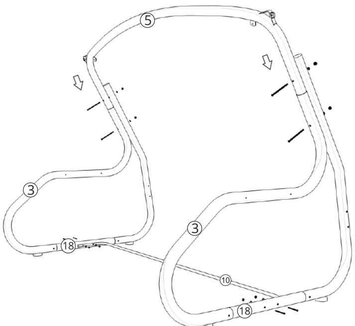
5. Прикрутить стяжку (10) к задним опорам (4), используя болт (23) - 2 шт., гайки (29) - 2 шт. шайбы (30) - 2 шт., крючок-сцепку (19) - 2 шт., шайбы (32) - 2 шт., гайки (31) - 2 шт.
