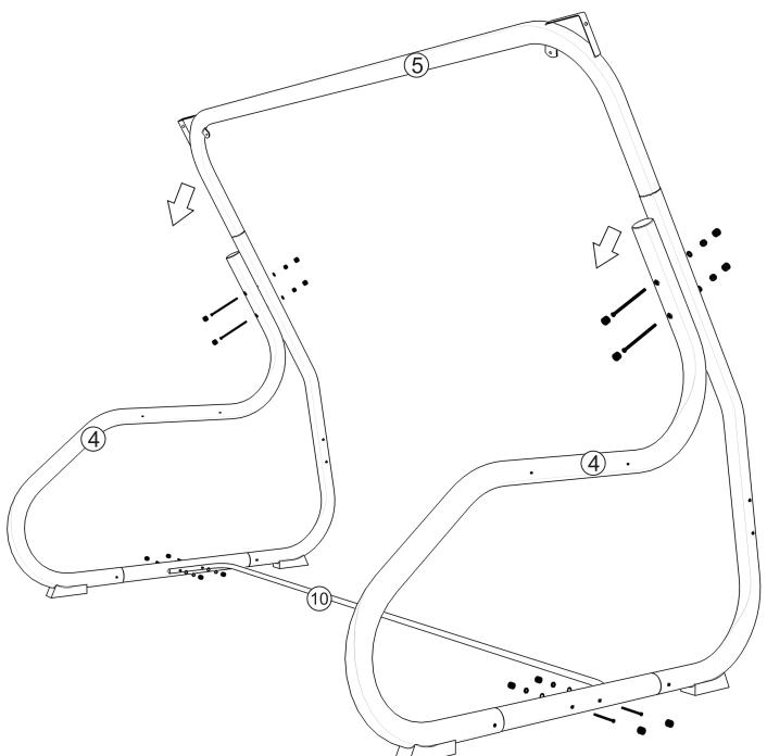
5. Прикрутить стяжку (10) к задним опорам (4), используя болт (23) - 2 шт., гайки (29) - 2 шт., шайбы (30) - 2 шт., крючок-сцепку (19) - 2 шт., шайбы (32) - 2 шт., гайки (31) - 2 шт.
