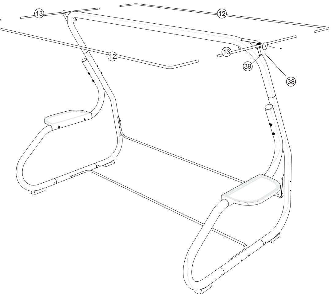
14. Сборка узла регулировки тента:
