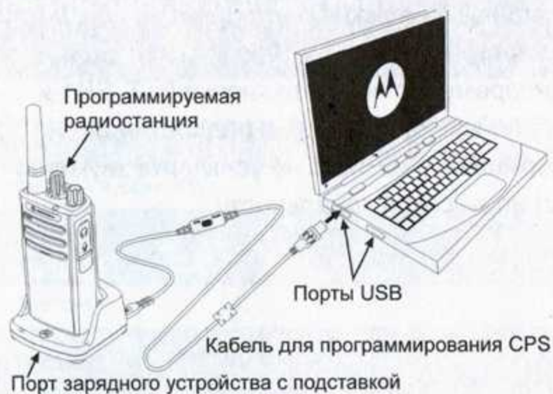
Рис. 1. Настройка радиостанции для работы с ПО CPS
