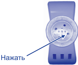
Рис.2. Расположение штока на термовыключателе термостата
