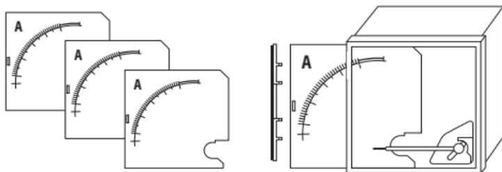
Рис. 3 Схема установки/замены шкал.
