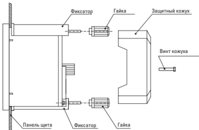
Рис. 2 Установка прибора
