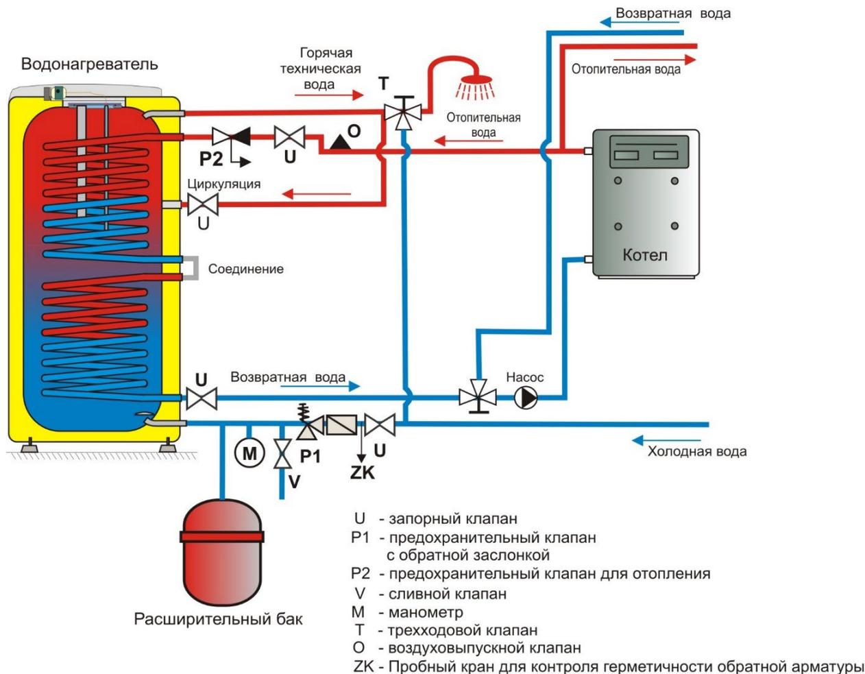
\* Использование расширительного бака не является условием правильного подключения, это лишь возможный вариант решения
