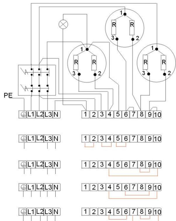
3 кВт 1 PE - N AC 230 В / 50 Гц
