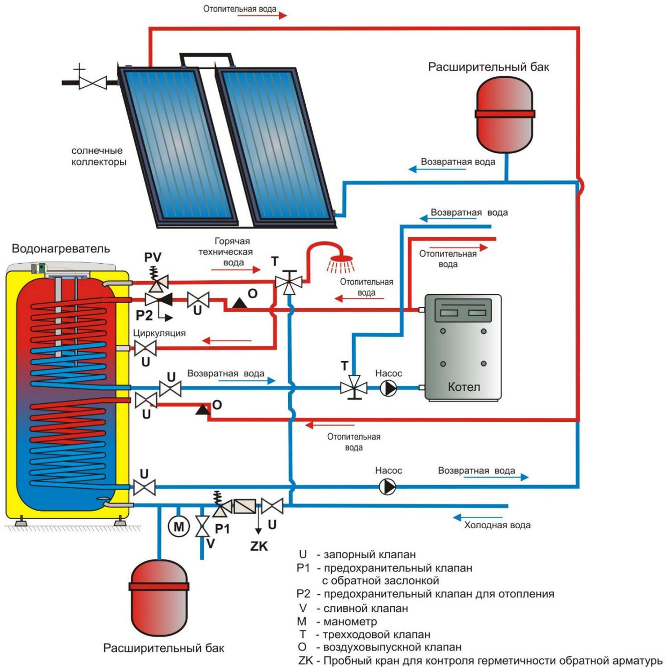
\* Использование расширительного бака не является условием правильного подключения, это лишь возможный вариант решения
