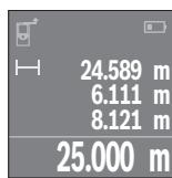
Натисніть один раз кнопку вимірювання **4** для наведення на ціль, і ще один раз для вимірювання.
