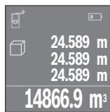
Nakon dovršetka trećeg mjerenja, volumen se automatski izračunava i prikazuje. Konačni rezultat prikazan je na displeju dolje, a pojedinačne izmjerene vrijednosti iznad njega.
