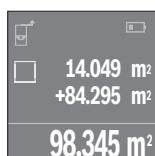
Nyomja meg a **4** mérőgombot, hogy ezzel elindítson egy további felületmérést. Határozza meg a „Felületmérés” szakaszban megadottak értelmének megfelelően a felületet, lásd 47. oldal. Az összeadás befejezéséhez nyomja meg a **4** mérőgombot. További mérési eredmények hozzáadásához nyomja meg ismét a **7 [+]** gombot stb.
