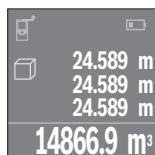
A harmadik mérés befejezése után a készülék automatikusan ki-számítja és kijelzi a térfogatot. A végeredmény a kijelző alsó részén, az egyes különálló mért értékek felette látható.
