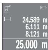
Натиснете еднократно бутона за измерване **4** за насочване към целевата повърхност и още веднъж за измерване.
