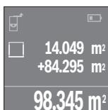
Pritisnite tipko za merjenje **4**, da začnete naslednje merjenje površine. Določite površino v skladu z razdelkom „Ploskovna meritev“, glejte stran 148. Za zaključek seštevanja pritisnite tipko za merjenje **4**. Za seštevanje dodatnih izmerjenih vrednosti pritisnite ponovno na tipko **7 [+]** itd.
