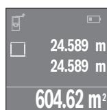
Az első mérési eredmény a kijelző felső részén kerül kijelzésre. A második mérés befejezése után a készülék automatikusan kiszámítja és kijelzi a felületet. A végeredmény a kijelző alsó részén, az egyes különálló mért értékek felette láthatók.
