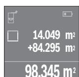
Apăsați tasta de măsurare **4**, pentru a începe o nouă măsurătoare de suprafață. Determinați suprafața conform paragrafului „Măsurarea suprafețelor“, vezi pagina 101. și pentru a finaliza adunarea, apăsați tasta de măsurare **4**. Petru adunarea altor valori măsurate, apăsați din nou tasta **7 [+]** s.a.m.d.
