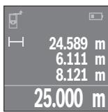
Нажмите на кнопку измерения **4** один раз для наводки на цель и еще раз для измерения.
