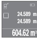
Перше вимірювання відображується на дисплеї зверху.
