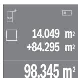
Wciśnąć przycisk pomiarowy **4**, aby rozpocząć kolejny pomiar powierzchni. Wyznaczyć powierzchnię zgodnie ze wskazówkami zawartymi w rozdziale »Pomiar powierzchni«, zob. str. 12. Aby zakończyć dodawanie, należy wcisnąć przycisk **4**. Aby dodać kolejne wartości pomiarowe, należy ponownie wcisnąć przycisk **7 [+]** itp.
