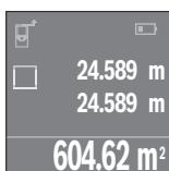
První naměřená hodnota se zobrazí nahoře na displeji. Po dokončení druhého měření se automaticky vypočítá a zobrazí plocha. Konečný výsledek je zobrazený dole na displeji, jednotlivé naměřené hodnoty nad ním.
