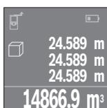
Po dokončení třetího měření se automaticky vypočítá a zobrazí objem. Konečný výsledek je zobrazený dole na displeji, jednotlivé naměřené hodnoty nad ním.
