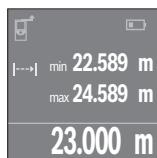
Pritisnite merni taster **4** za aktiviranje mernog procesa. Merni alat pokrećite sve dok se dole na displeju ne prikaže željena vrednost udaljenosti.
