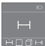
Po zapnutí se měřicí přístroj nachází ve funkci měření délky. Ostatní měřicí funkce můžete nastavit opakováním stisknutím tlačítka **3** nebo navigačních tlačitek **7** [<+] nebo **2** [-] (viz „Měřicí funkce“, strana 24).
