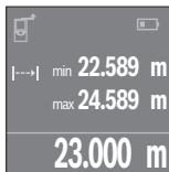
Нажмите на кнопку измерения **4**, чтобы произвести измерение. Водите измерительным инструментом до тех пор, пока на дисплее не отобразится нужное расстояние.
