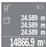
Po zakończeniu trzeciego pomiaru kubatura obliczana jest automatycznie, a następnie wyświetlana. Wynik końcowy umieszczony jest u dołu wyświetlacza, pojedyncze wartości pomiarowe powyżej niego.
