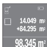
Натисніть на кнопку вимірювання **4**, щоб розпочати нове вимірювання площи. Визначте площу згідно з розділом «Вимірювання площи», див. стор. 75. Щоб завершити додавання, натисніть на кнопку вимірювання **4**. Щоб додати подальше виміряне значення, натисніть знов на кнопку **7 [+]** і т.д.
