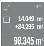
Нажмите на кнопку измерения **4**, чтобы произвести еще одно измерение площади. Определите площадь в соответствии с разделом «Измерение площади», см. стр. 61. Чтобы завершить сложение, нажмите на кнопку измерения **4**. Чтобы прибавить другие измеренные значения, еще раз нажмите на кнопку **7 [+]** и т.д.
