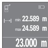
За стартиране на измерването натиснете бутона **4**. Премествайте измервателят уред, докато в долната част на дисплея се изпише желаното разстояние.
