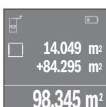
Järgmise pindala mõõtmise alustamiseks vajutage mõõtmisnupule **4**. Mõõtke pindala vastavalt punktile „Pindala mõõtmine“, vt lk 170. Liitmise lõpetamiseks vajutage mõõtenupule **4**. Järgmiste mõõtetulemuste liitmiseks vajutage uuesti nupule **7 [+]** jne.
