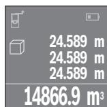
Pēc trešā mērijuma beigām tilpuma mērijuma rezultāts tiek automātiski aprēķināts un parādīts uz displeja. Aprēķinātā augstuma vērtība tiek parādīta displeja apakšējā vērtību rindā, bet abu atsevišķo mērijumu rezultāti ir redzami virs tās.
