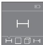
След включване измервателният уред се намира в режим за измерване на дължини. Можете да включите други режими чрез неколкократно натискане на бутона **3** или на навигационните бутони **7 [+]** или **2 [-]** (вижте „Режими на измерване“, страница 113).
