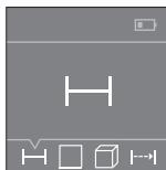
После включения измерительный инструмент находится в режиме измерения длины. Прочие режимы измерения настраиваются многократным нажатием на кнопку **3** или на навигационные кнопки **7 [+]** или **2 [-]** (см. «Режимы измерений», стр. 61).
