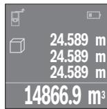
По завершенні другого вимірювання об'єм автоматично вираховується і відображується. Кінцевий результат відображується на дисплеї знизу, окрім вимірювані значення – над ним.
