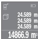
После завершения третьего измерения объем рассчитывается автоматически и отображается. Конечный результат отображается внизу на дисплее, отдельные измеренные значения – над ним.
