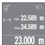
Натисніть на кнопку вимірювання **4**, щоб виконати вимірювання. Поводьте вимірювальним інструментом до тих пір, поки знизу на дисплеї не відобразиться бажане значення відстані.
