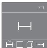
По вклучувањето, мерниот уред се наоѓа во функција на должинско мерење. Може да подесувате други мерни функции со повеќекратно притискање на копчето **3** или копчето за навигација **7 [+]** или **2 [-]** (види „Мерни функции“, страница 125).
