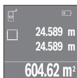
Prva izmjerena vrijednost prikazuje se gore na displeju. Nakon dovršetka drugog mjerenja, površina se automatski izračunava i prikazuje. Konačni rezultat prikazan je na displeju dolje, a pojedinačne izmjerene vrijednosti iznad njega.
