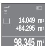
Pritisnite tipku za mjerjenje **4** za započinjanje mjerjenja druge površine. Utvrđite površinu sukladno odlomku »Mjerjenje površina«, vidi stranicu 159. Kako biste završili zbrajanje, pritisnite tipku za mjerjenje **4**. Za zbrajanje ostalih izmjerenih vrijednosti ponovno pritisnite tipku **7 [+]** itd.
