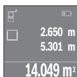
Wcisnąć przycisk **7** [+]. Obliczona powierzchnia wyświetlona zostanie pośrodku wyświetlacza.
