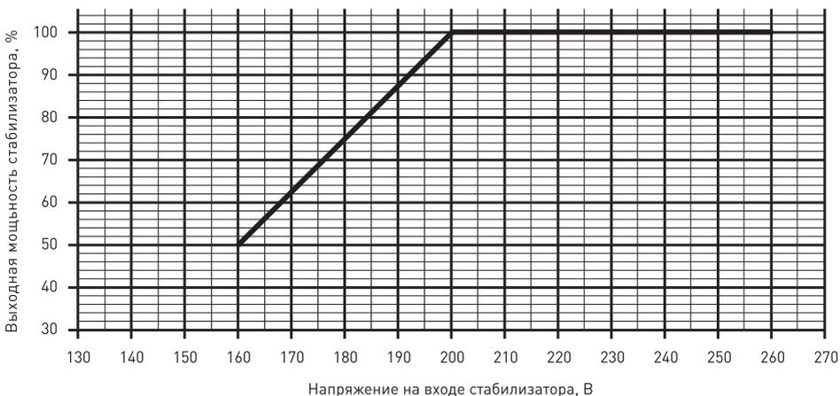
Рекомендуется выбирать модель стабилизатора напряжения минимум с 25% запасом от потребляемой мощности нагрузки. Во-первых, Вы обеспечите "щадящий" режим работы стабилизатора, тем самым увеличив его срок службы, во-вторых, создадите себе резерв мощности для подключения нового оборудования.
