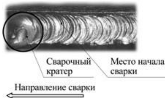
Рис. 9.3. Начало сварки при смене электрода.
