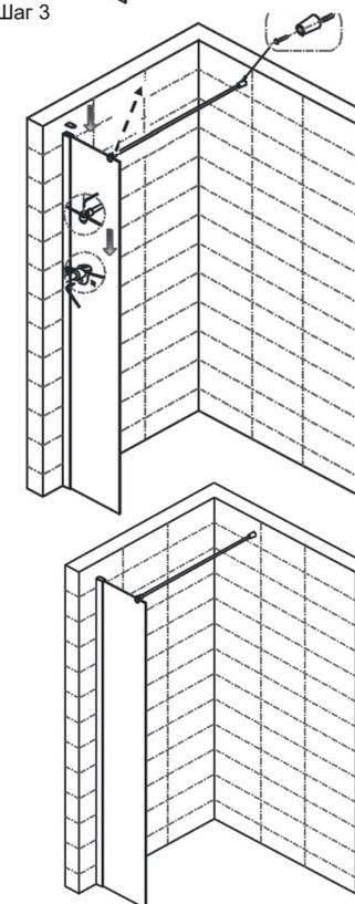
Примечание: возможна установка держателя стекла в различных направлениях
