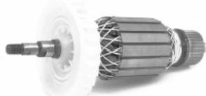
– внутренняя часть выполнена способом полностью автоматического накручивания нити, вокруг ротора добавлена сетка, препятствующая попаданию на эмалевые провода пыли, мелких камней и других инородных тел (эмалевый провод выполнен из медной проволоки, обладает устойчивостью к высоким температурам до 180°C), что увеличивает срок службы ротора. Содержание серебра в коммутаторе 8/10000, что делает поверхность коммутатора более гладкой, увеличивая срок эксплуатации.
