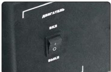
(c) Установите выключатель в положение «ВЫКЛ».
