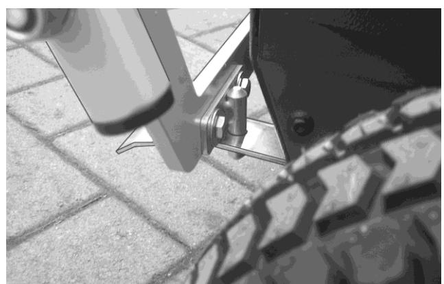
Протяните поворотный рычаг за ручку через петлю на правой стороне машины, а затем подведите его к болтам с винтовой нарезкой, расположенным на крышке щётки. Сверху и снизу места крепления находятся металлические шайбы. Вверху расположена пластмассовая шайба, с помощью которой фиксируется самостопорящаяся гайка, но закручивается не плотно, а свободно.
