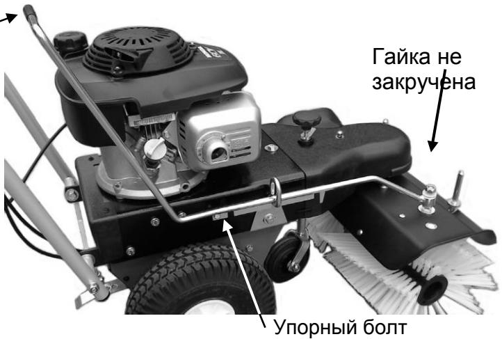
Внизу опорной планки необходимо закрутить болт M6x20 со самостопорящейся гайкой (как изображено на рисунке), при этом резьба направлена к машине. Этот болт служит в качестве упора.
