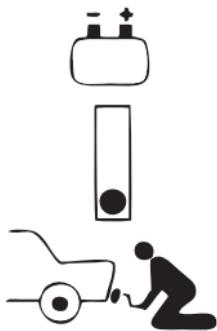
Запуск машины производится при помощи стартера при необходимости, когда в аккумуляторе/батарее не достаточно энергии для запуска мотора. В этом случае необходимая энергия может быть получена путем подключения стартера к электросети и установке переключателя запуска/зарядки в положение запуска.
