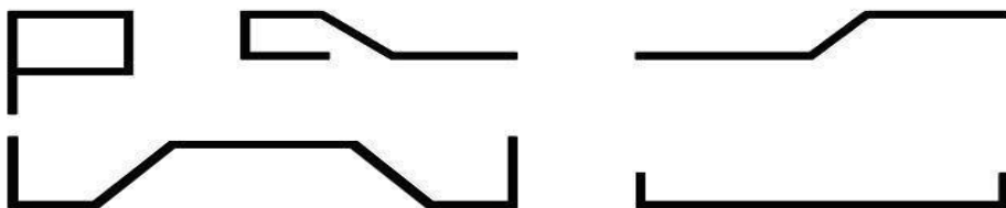
Рис. 5 Формы изгиба арматуры
