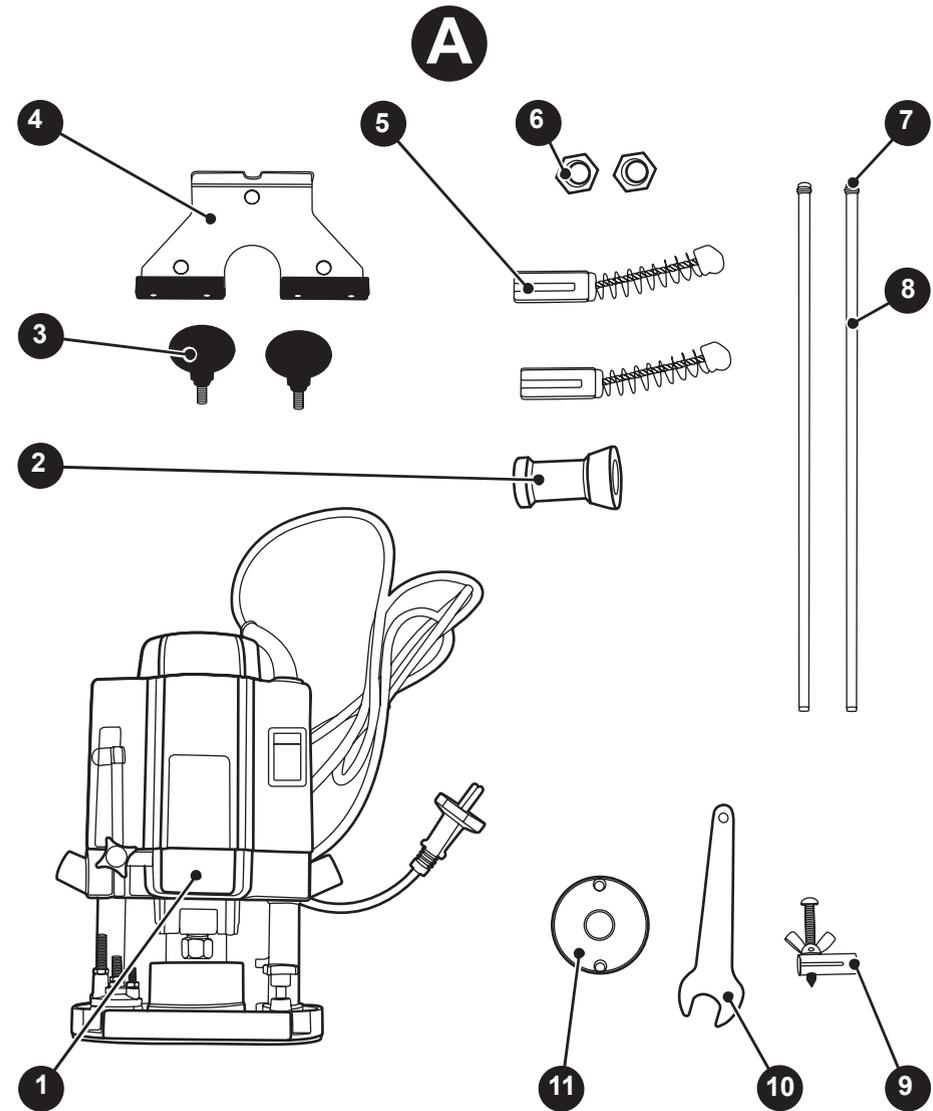
Рисунок А — комплектность фрезера. Дополнительно смотри таблицу 2.
