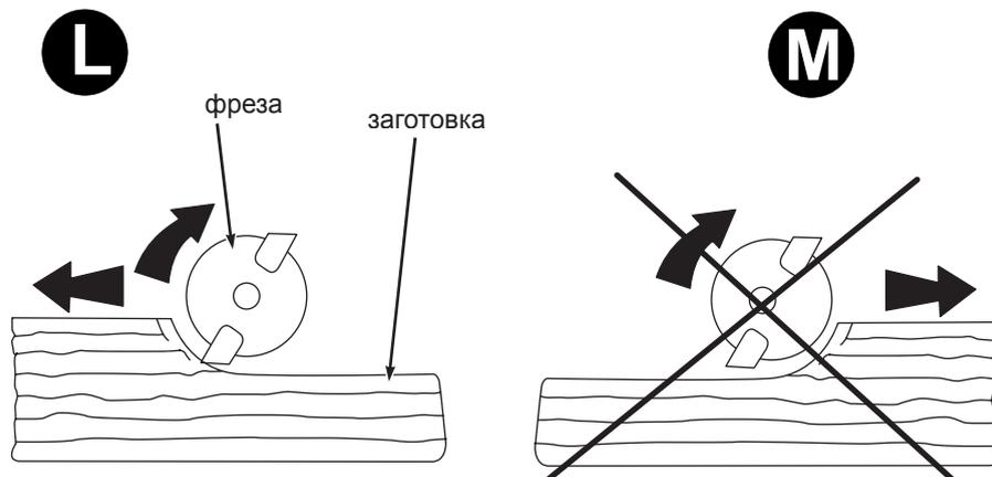
Рисунок L — правильно выбранное направление движения подачи фрезера относительно направления вращения фрезы.
