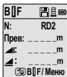
Измерение следующего промежуточного отсчета с наводящим сообщением
