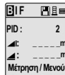
Μέτρηση οπισθοσκόπευσης του επόμενου σημείου αλλαγής με μήνυμα
