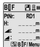
Przejdź do menu "Punkt pośredni" i wybrać WŁ. lub wcisnąć przycisk wysokość i odległość, aby rozpocząć pomiar do punktu pośredniego
