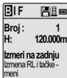
Мерење на задњем видуку уз упутну поруку
