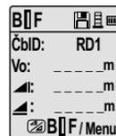
V menu nastavte "Boční záměra" na zapnuto nebo stiskněte tlačítko Výška a délka, měříte na boční záměru
