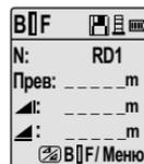
Переход в настройку меню "Промежуточный отсчет" ВКЛ. или нажмите клавишу высоты и расстояния, измерение по промежуточному отсчету
