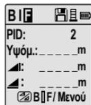
Μεταβείτε στο σεντ μενού "Ενδιάμεση σκόπευση" στο OFF. Ή πατήστε το πλήκτρο Υψος & Απόσταση, μέτρηση εμπροσθοσκόπευσης
