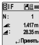
Измерение задней рейки, отображаемое с наводящим сообщением
