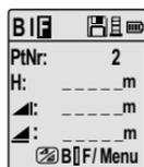
Przejdź do menu "Punkt pośredni" i wybrać WŁ. lub wcisnąć przycisk wysokość i odległość, aby rozpocząć pomiar do pkt w przód
