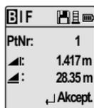
Wyświetlanie pomiaru do pkt wstecz z komunikatem potwierdzenia
