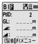
メニューに移動し、「中間点」をOFFに設定するか、または高さ & 距離キーを押してフォアサイトを測定します。
