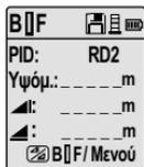
Μέτρηση επόμενης ενδιάμεσης σκόπευσης με μήνυμα
