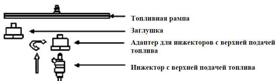
Рис. 2.1 Установка адаптера инжектора с верхней подачей топлива
