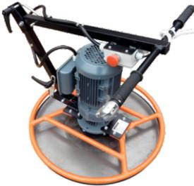
1. Затирочная машина с установленным диском рабочего диаметра 610мм и сетевым кабелем с вилкой.
