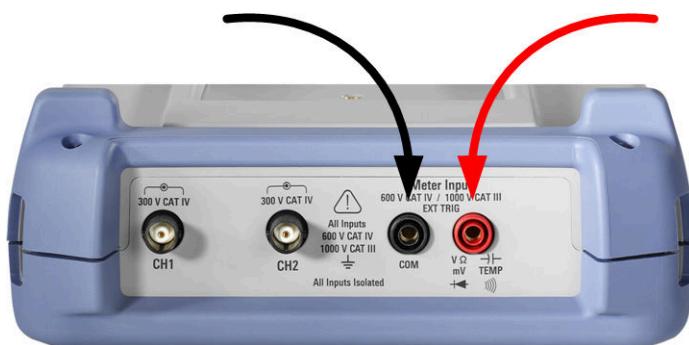
Рис. 4-1: Входы мультиметра для подключения щупов
