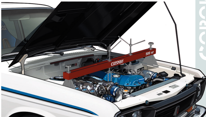
Рисунок 3 – Установка держателя в моторном отсеке
