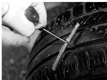
3. Вставить жгут в отверстие шила. Ввести жгут внутрь шины на 3-4 см.
