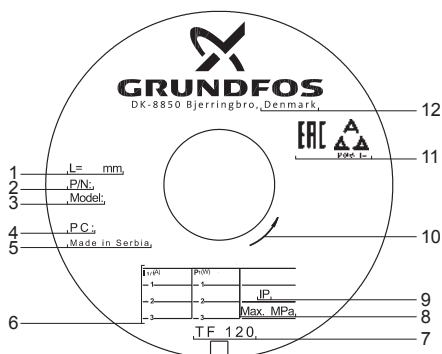
Рис. 2 Пример фирменной таблички UPS серии 200
