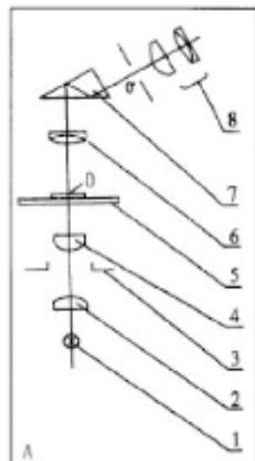
**System oświetlenia:** lampa (1), soczewka skupiająca (2), przystoń (3) i kondensor (4). Światło emitowane przez lampa (1) przechodzi przez soczewkę skupiającą (2) i oświetla przystoń (3). Następnie światło jest skupiane przez kondensor (4). Ten system oświetlenia służy do obserwacji preparatów (0) w świetle przechodzącym. Jednakże możliwe jest zastosowanie innego systemu oświetlenia (na przykład - reflektor) do obserwacji w świetle odbitym.
