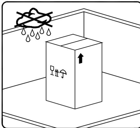
Даже в упакованном виде обеспечьте защиту устройства от погодных воздействий. Держите осушитель в вертикальном положении, также во время хранения. При переворачивании устройства вверх ногами некоторые компоненты могут получить непоправимые повреждения. При длительном неиспользовании осушитель следует хранить в упаковке в защищенном от пыли месте при температуре не выше 50°C и влажности не более 90%. Если время хранения превышает 12 месяцев, пожалуйста, обратитесь к производителю.
