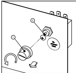
*Для обеспечения безопасной работы и целостности осушителя, на контуре газообразного хладагента устанавливается предохранительное термореле (TS).*
