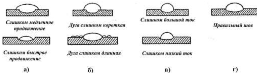
Рис.3. Типы сварочных швов
