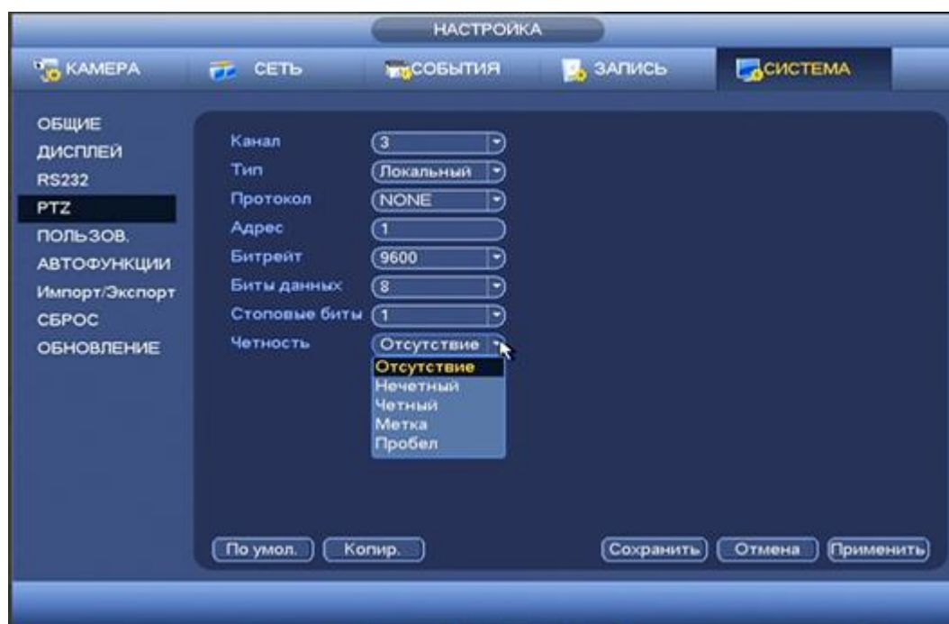
Рисунок 8.3.5.4.2 Интерфейс настройки при локальном типе. Параметры и функции настройки приведены в таблице 8.21
