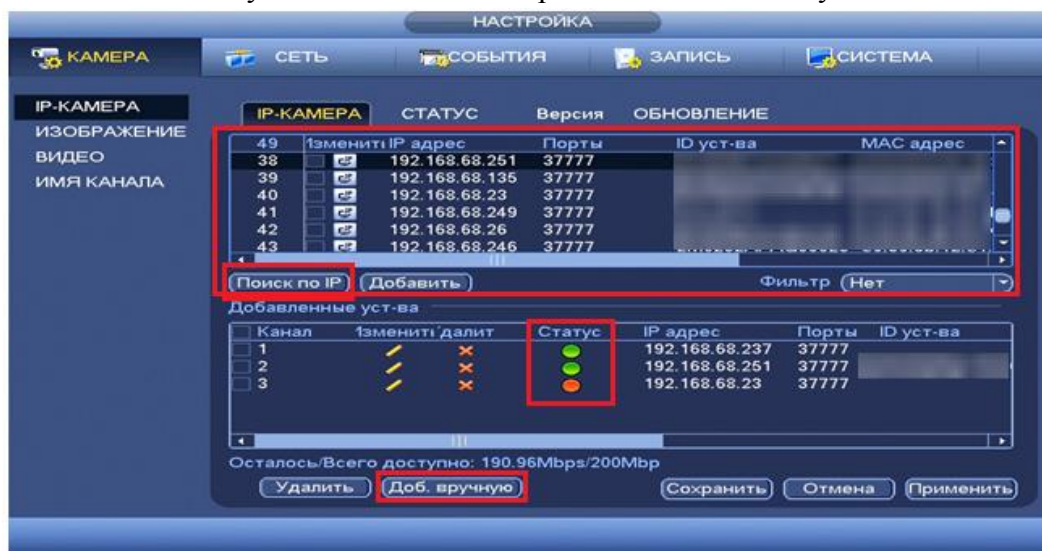
Рисунок 8.3.1.1.1.2 Настройка добавления камер по поиску в сети.
