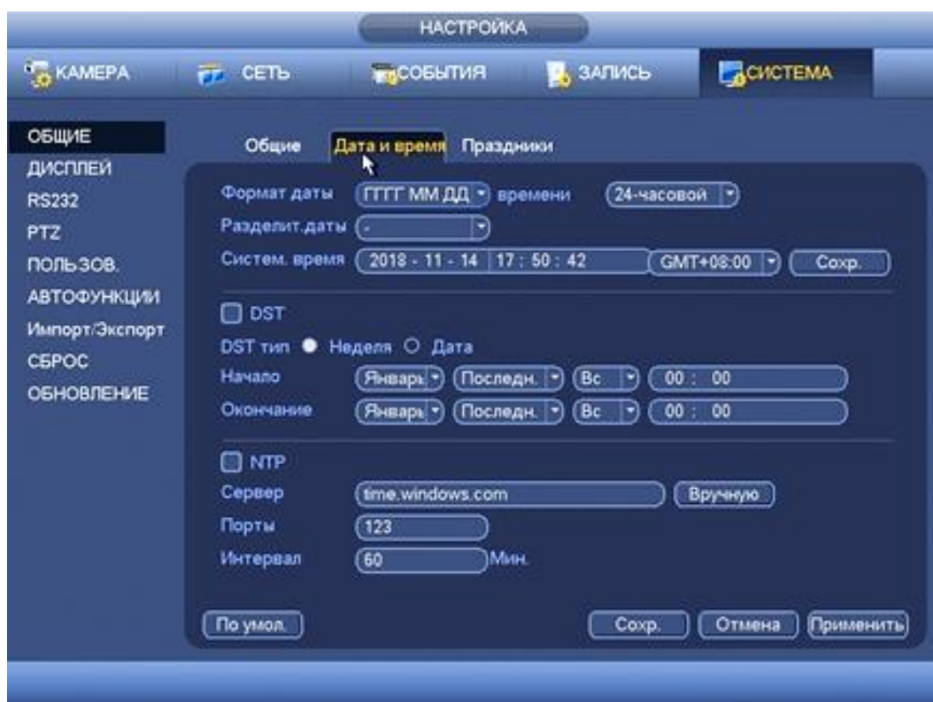
Рисунок 8.3.5.1.2.1 Интерфейс настройки даты и времени. Функции и диапазоны значений параметров даны в таблице 8.18.
