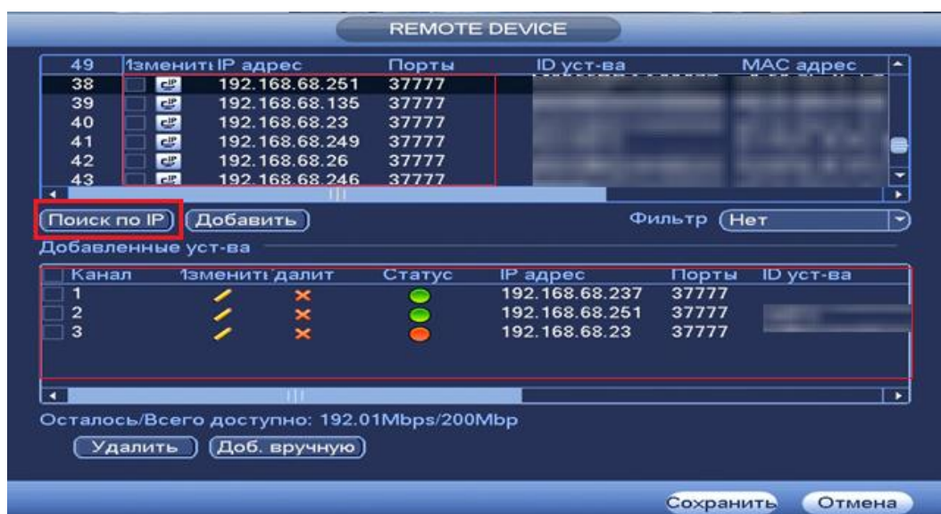
Рисунок 6.2.5.2 Настройка добавления камер по поиску в сети.
