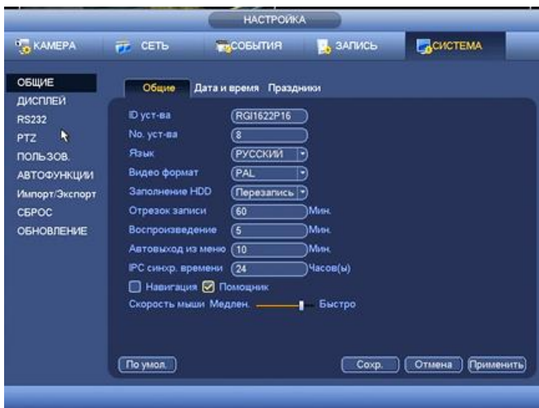
Рисунок 8.3.5.1.1.1 Интерфейс настройки общих параметров. Функции и диапазоны значений параметров даны в таблице 8.17:
