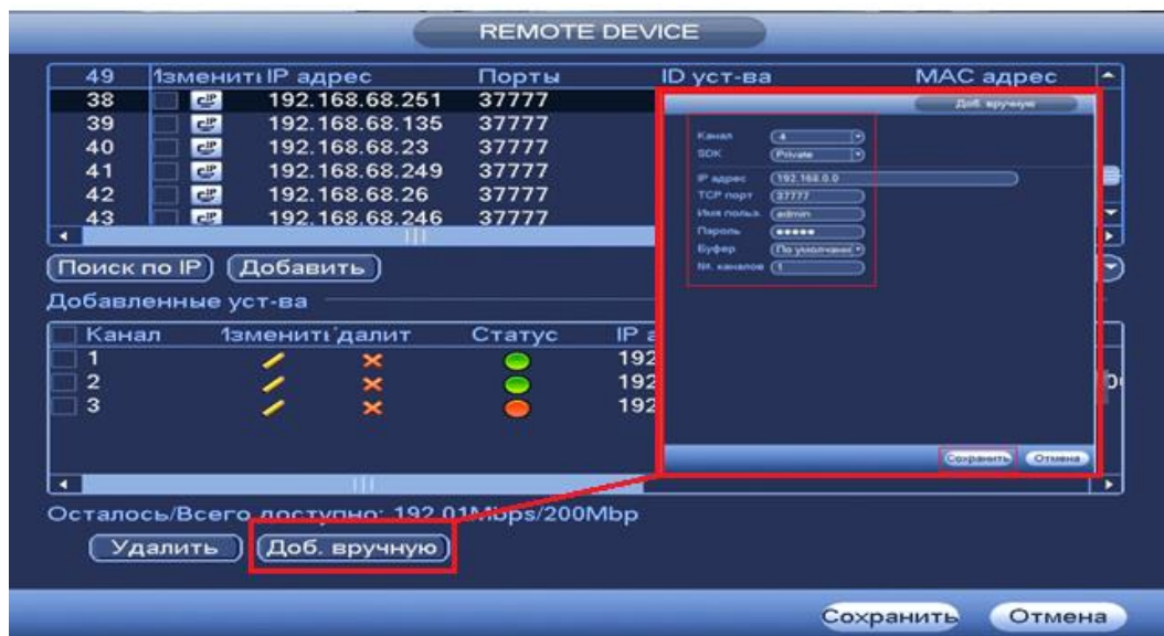
Рисунок 7.7.3 Настройка ручного добавления камер.
