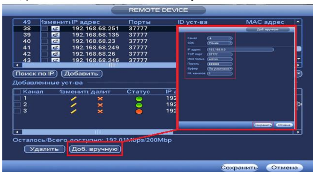
Рисунок 6.2.5.3.-Настройка ручного добавления камер.
