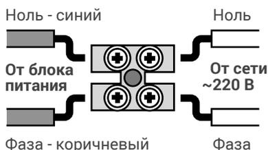
**6** Соедините коннектор блока питания с ответной частью на светильнике
